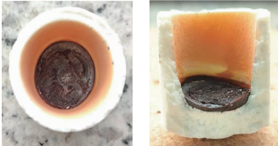
图 2 0.5 g 纯铁+0.2 g 样品+1.6 g 钨粒熔样正面、剖面图
