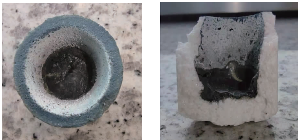
图 4 0.2 g 样品+0.2 g 锡粒+1.6 g 钨粒熔样正面、剖面图
