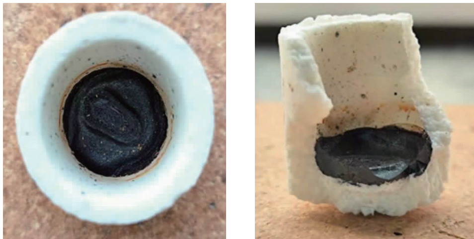
图 3 0.5 g 纯铁+0.2 g 样品+0.2 g 锡粒熔样正面、剖面图
